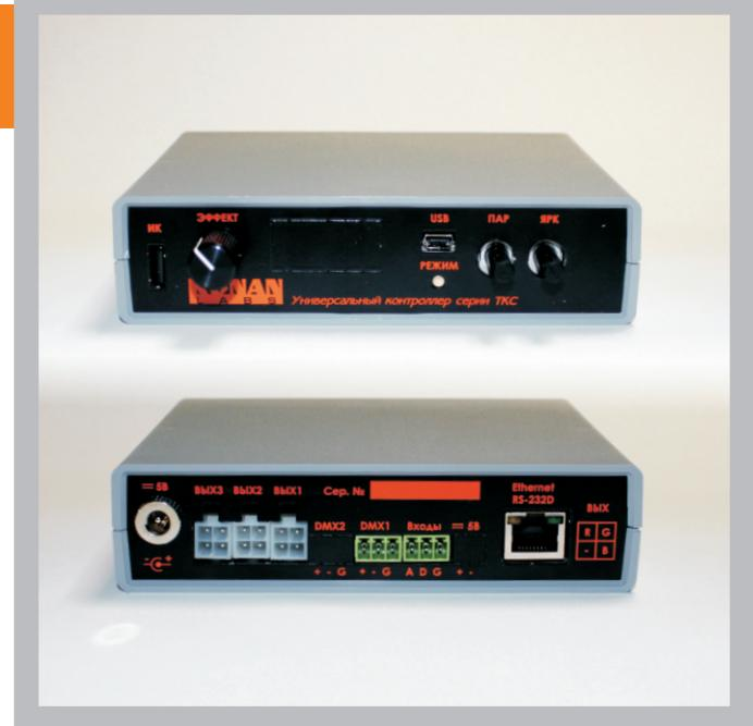
Серия ТКС представляет собой малогабаритные программируемые контроллеры, предназначенные, в первую очередь, для управления светодиодным освещением. Однако, высокопроизводительный центральный процессор Cortex M3, работающий на частоте 72 МГц, а также широкий набор коммуникационных интерфейсов и органов управления позволяют применять их для решения самых разных задач.
