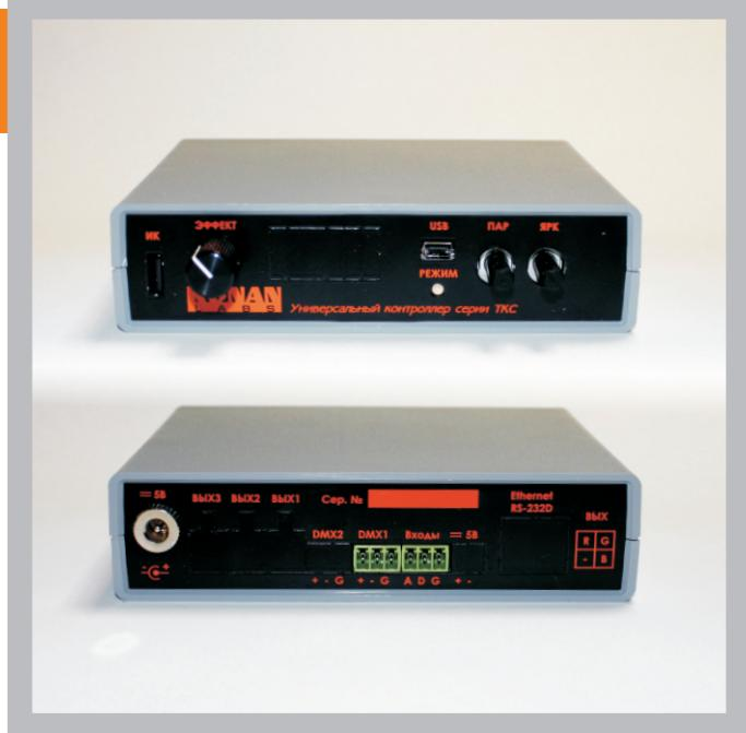
Серия ТКС представляет собой малогабаритные программируемые контроллеры, предназначенные, в первую очередь, для управления светодиодным освещением. Однако, высокопроизводительный центральный процессор Cortex M3, работающий на частоте 72 МГц, а также широкий набор коммуникационных интерфейсов и органов управления позволяют применять их для решения самых разных задач.
